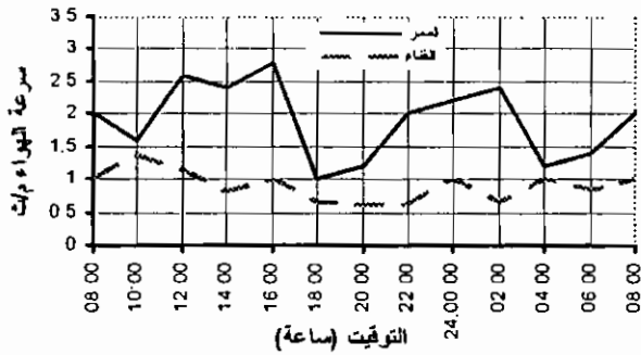
شكل (٣٢): تغيير سرعات الهواء داخل وخارج القناة (التوجيه الجنوبي الشرقي).
