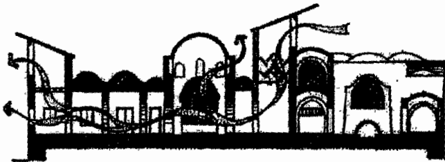
(شكل ٢) قطاع وصورة بوضوح بعض المعالجات البيئية في مباني حسن فتحي.
