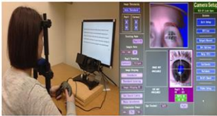
شكل (5) يوضح كيفية عمل جهاز تعقب العين من خلال تحليل تتبع العين تركز على خرائط الحرارة المنتجة
