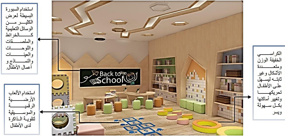
شكل رقم ( 19 ): يوضح التنوع في الاستعمالات و الاستخدامات في الأرضيات والجدران بداخل القاعة التفاعلية المرجع: الباحثة
