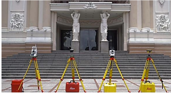
شكل (7) يوضح أجهزة المسح الليزري ثلاثي الأبعاد أمام المبنى ، (Leica Geosystems, 2022)
