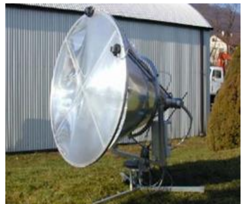
نظام السولاكس بعدسة فريسنيل لتجميع الإضاءة الطبيعية
